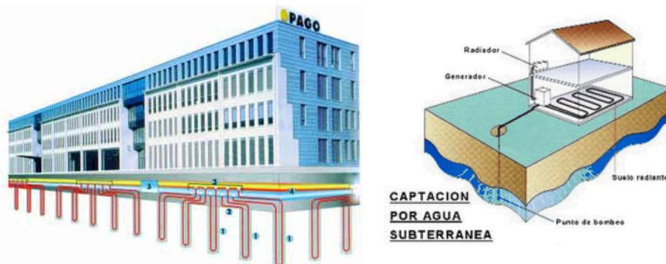
**Figura 6.15. Edificio con pilotes intercambiadores de calor (izquierda) y Captación por agua subterránea (derecha). Fuente: Eficiencia Energética, Marzo 2009. Cámara de Comercio e Industria de Madrid.**
